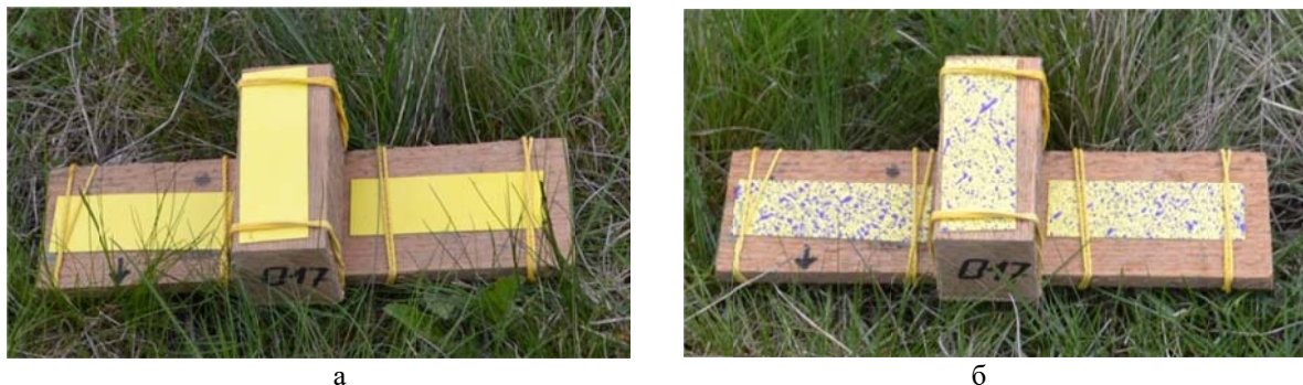
Рисунок 1 – Тримач з водочутливим папером: а – до проходу агрегату; б – після проходу.
