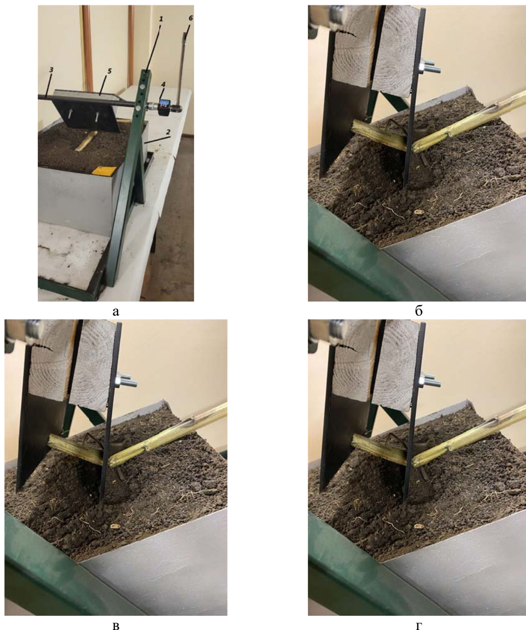
а – загальний вигляд лабораторної установки; б – встановлення заданого значення кута \beta ; в – момент перерізання стеблини; г – забивання міжрядного простору.
