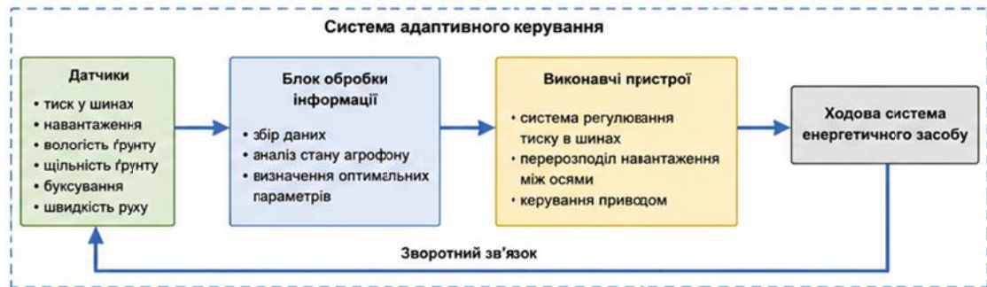
Рисунок 5 – Структурна схема системи адаптивного керування ходовою системою
