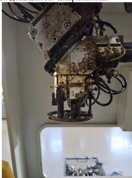
Рисунок 2 – Захватний пристрій робота в умовах експлуатації
