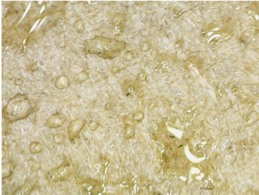
Рисунок 8 – Відбитки крапель вокулярі мікроскопу Digital Microscope
