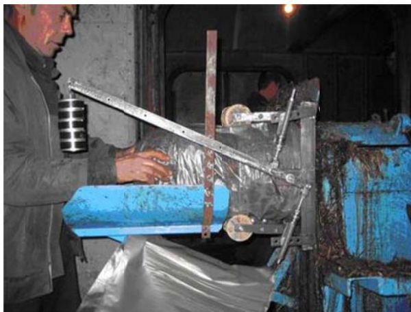
Рисунок 4 – Виробничі випробування поршневого ущільнювача субстрату ПМС-10Г з важільно-амортизаційним прижимним пристроєм в ТОВ «Славута»
