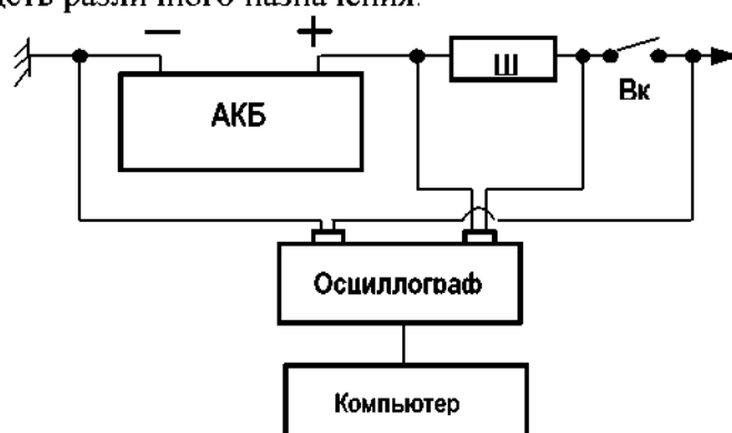
АКБ – аккумуляторная батарея. Ш – шунт. Вк – выключатель
