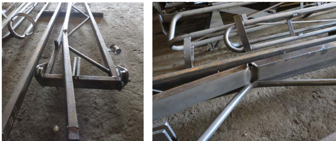
Рисунок 1 – Типові поломки елементів штанг обприскувача виробництва ПАТ «Богуславська сільгосптехніка»
