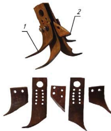
а – барабан в сборе; б – свободно подвешенный комбинированный нож барабана; 1 – поперечные серповидные лезвия; 2 – вертикальное клиновидное лезвие Рисунок 2 – Рабочий орган нового измельчителя
