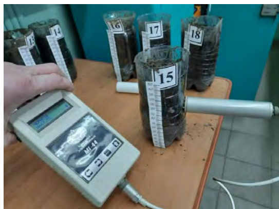
Рисунок 3 – Фото вимірювання вологості середнього шару досліджуваного зразка
