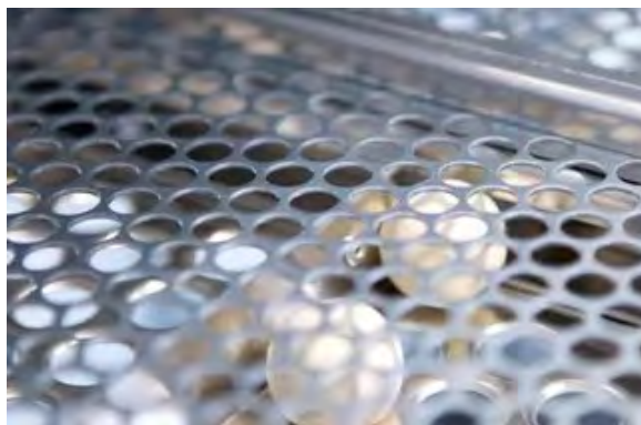
Рисунок 8 – Кулькові очисники решіт сепараторів Petkus сімейств А, М, U та V
