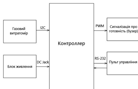
Рисунок 8 – Функціональна схема автоматичного контролю ферментацією
