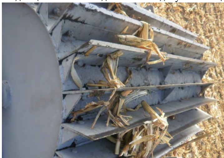
Рисунок 1 – Приклад накопичення рослинних решток між ножами барабана
