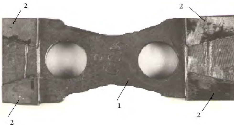
Рисунок 10 – Молоток-модуль (основа 1 – сталь, Ст.3, сталь 45; 2 – модульні змінні пластини з порошкового композитного матеріалу КХЖ70, КХНФ15)
