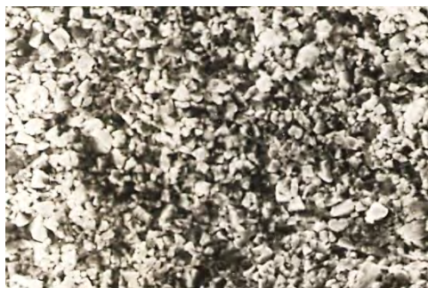
Рисунок 5 – Поверхня тертя твердого сплаву ВК-8, 1000
