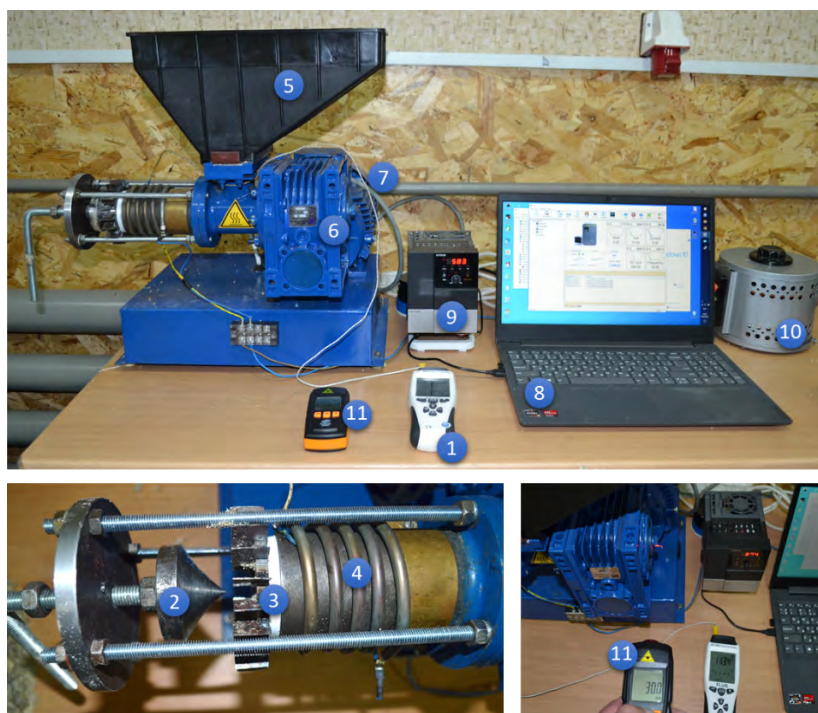
1 – цифровий термометр з термопарою FLUS ET-960; 2 – запираючий конус; 3 – гайка з роздільником потоку; 4 – повітряний ТЕН нагріву робочої камери; 5 – бункер завантаження; 6 – черв'ячний редуктор NMRV-63 (1:25); 7 – електродвигун AIP/5A180A4; 8 – ПЕОМ; 9 – частотний перетворювач HYUNDAI N700E; 10 – лабораторний автотрансформатор ЛАТР-1М; 11 – тахометр Benetech GM8905
