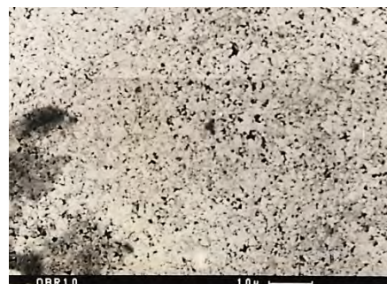
Рисунок 6 – Вихідна поверхня, твердий сплав ВК-8
