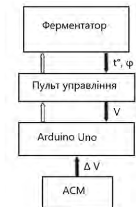
Рисунок 6 – Автоматична система керування ферментатором
