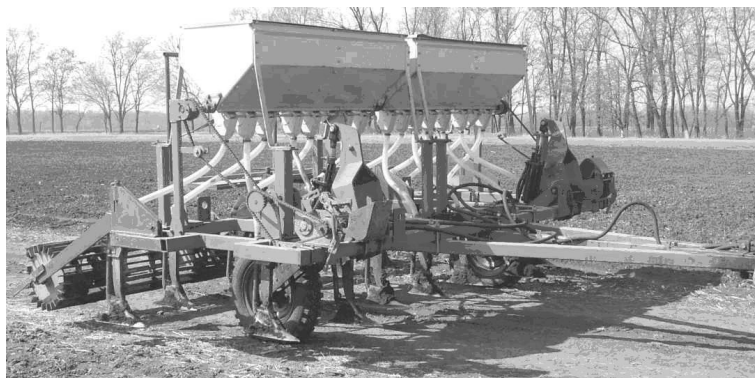
Рисунок 5 – Загальний вигляд культиватора розпушувача сівалки КРС-4
