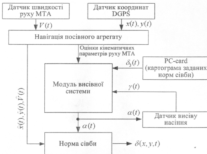
Рисунок 2 – Функціональна схема моделі посівного агрегату для технологій точного землеробства
