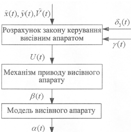
Рисунок 3 – Функціональна схема модулю висівної системи сівалки для технологій точного землеробства
