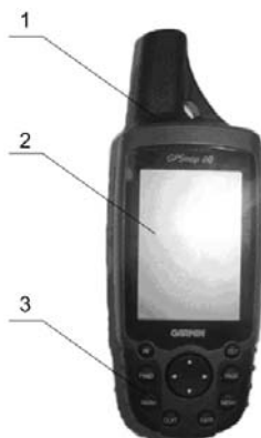
1 – антена GPS; 2 – дисплей; 3 – панель управління
