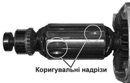
Рисунок 5 – Якір РШМ з коригувальними надрізами
