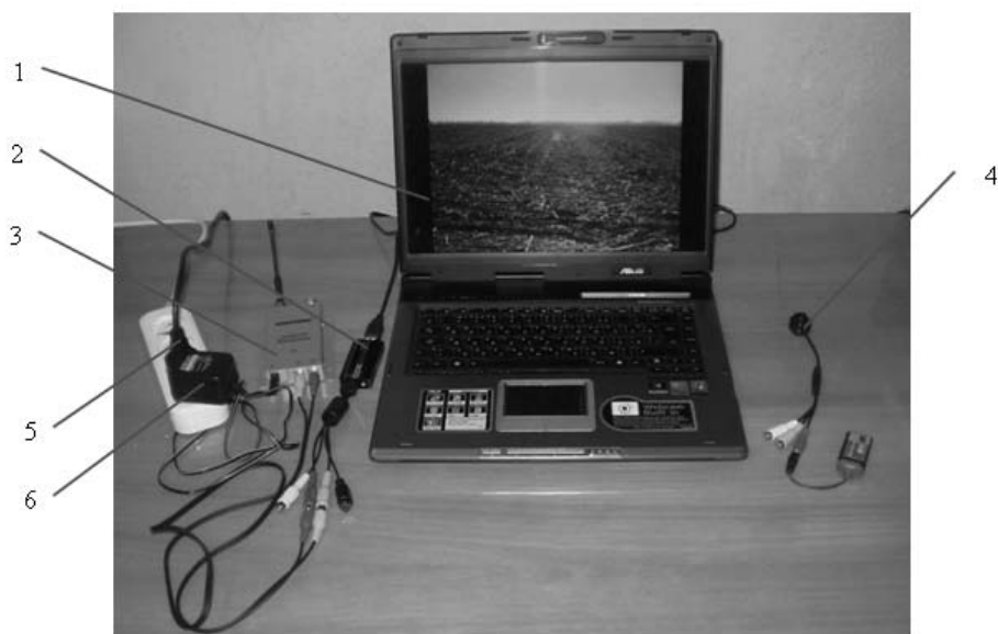
1 – ноутбук ASUS A6000VMeries, 2 – TV тюнер моделі AVerTV Hybrid+FM Volar, 3 – приймача відеосигналу Nokasonic моделі Radio AV Receiver, 4 – оптична апаратури (відеокамера), 5 – живлення ноутбук, 6 – живлення приймача Nokasonic моделі Radio AV Receiver
