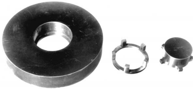
Рисунок 1 — Прес-форма у розібраному вигляді для нанесення тонкошарових поліамідних композицій на металеву підкладку
