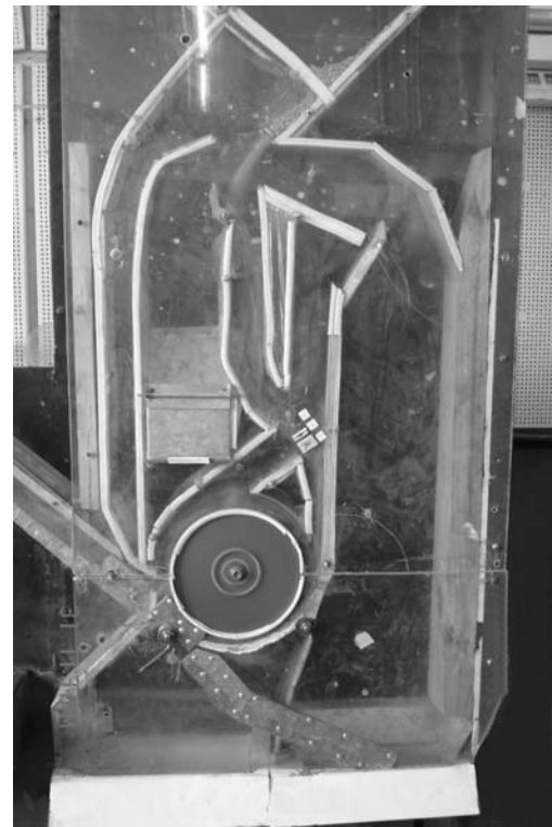
а) – схема експериментальної установки; б) – загальний вигляд експериментальної установки 1 – бункер; 2 – дозуючий пристрій; 3 – багатоструменевий ділильник; 4 – ПСК; 5 – напрямник зернового матеріалу; 6 – повітропроводи; 7 – регулювальні заслінки; 8 – лопатевий ротор; 9 – решето; 10 – відвантажувальний рукав; 11 – ежектор; I та II – приймальні камери легких домішок; III – приймальна камера дрібних домішок; IV – приймальна камера очищеного зерна
