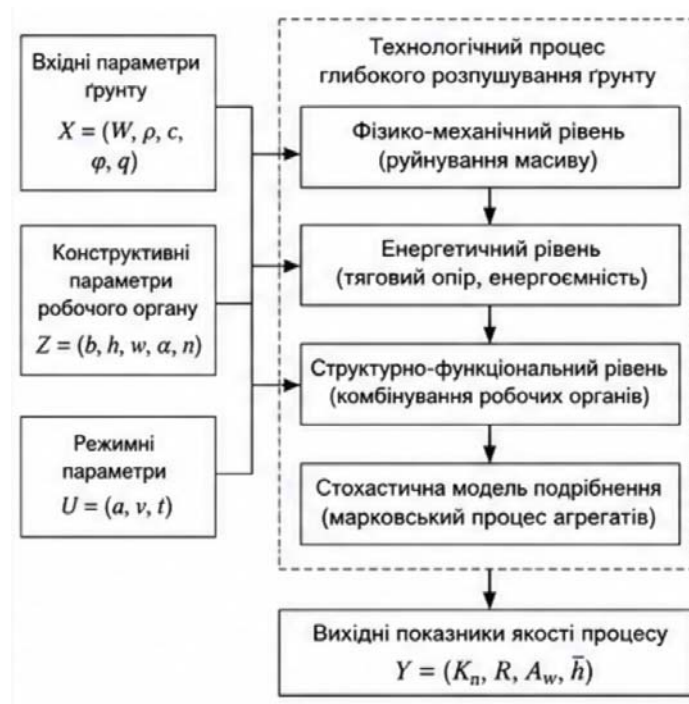
Рисунок 1 – Узагальнена структура технологічної моделі глибокого розпушування ґрунту
