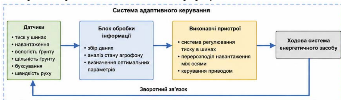
Рисунок 5 – Структурна схема системи адаптивного керування ходовою системою
