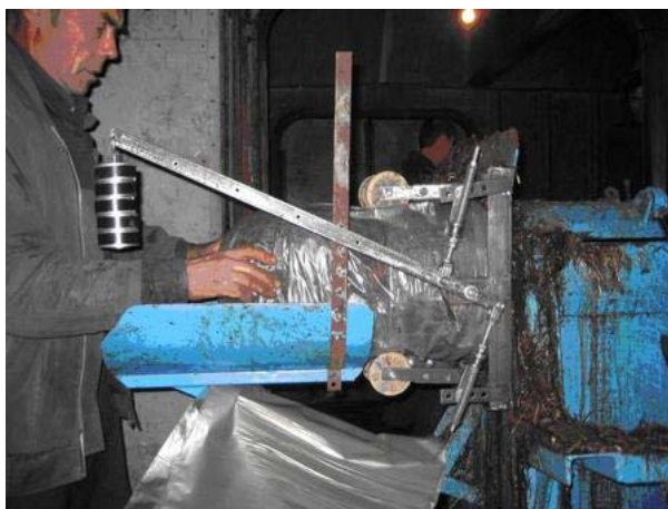
Рисунок 4 – Виробничі випробування поршневого ущільнювача субстрату ПМС-10Г з важільно-амортизаційним прижимним пристроєм в ТОВ «Славута»
