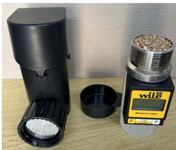
Рисунок 2 – Лабораторний вологомір зерна
