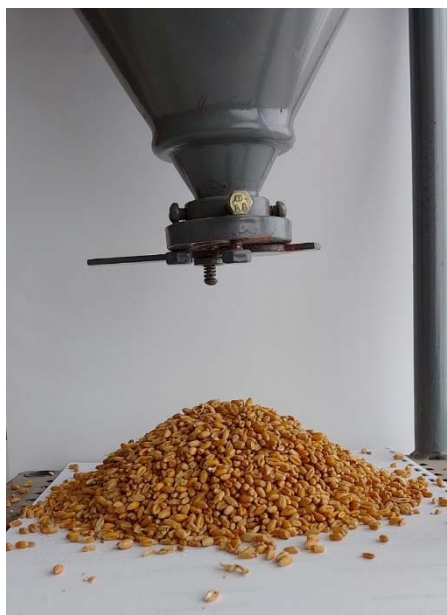
Рисунок 2 – Загальний вигляд природного схилу пшениці, яка витікає з воронки бункера Джерело: розроблено авторами
