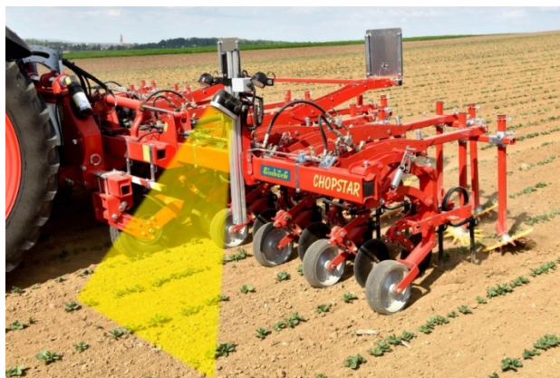
Рисунок 4 – Застосування системи керування камерою ROW-GUARD на культиваторах фірми «Einbock»
