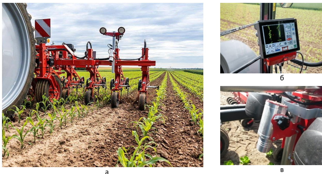
Рисунок 1 – Міжрядний культиватор EC-Weeder з системою автоматичного управління Джерело: [16]
