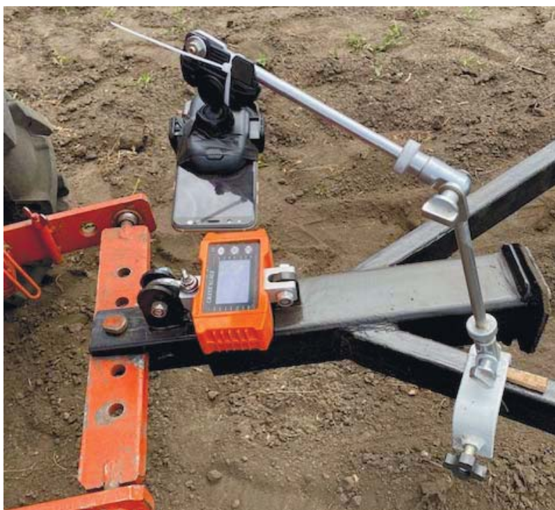
Рисунок 3 – Використання електронного тягоміра для фіксування тягового опору робочих органів
