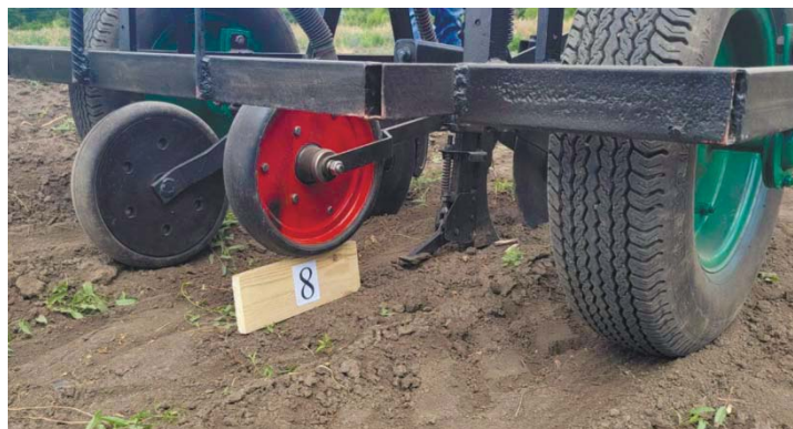
Рисунок 4 – Встановлення глибини ходу долотовидного сошника Джерело: розроблене авторами з використанням[6]
